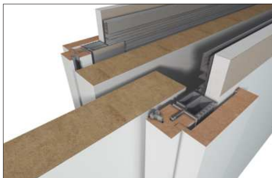
KASETA OŚCIEŻNICOWA TELESKOPOWA FT - SKRZYDŁA DREWNIANE FRAMED TELESCOPIC CASSETTE FT - WOODEN DOOR LEAVES
