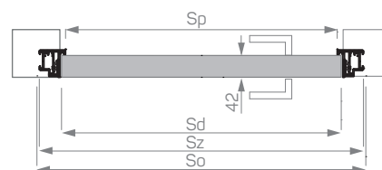
DRZWI SRP 42 ZEWNĘTRZNE - SKRZYDŁO DREWNIANE EXTERNAL DOORS SRP 42 - WOODEN DOOR LEAF
