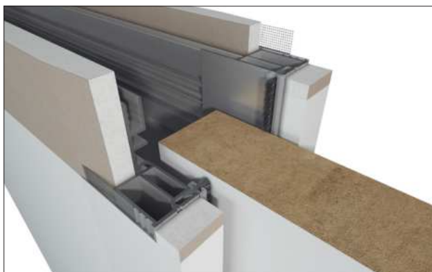
KASETA BEZOŚCIEŻNICOWA B01ECO D - SKRZYDŁA DREWNIANE FRAMELESS CASSETTE B01ECO D - WOODEN DOOR LEAVES
